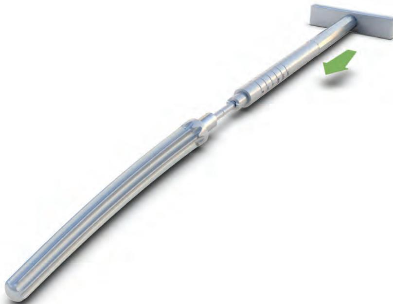
Pour sécuriser la connexion, procéder comme suit : visser la *vis à tête moletée S* à la main aussi loin que possible. Avec la *clé à pipe SW 3.5* insérée en transversal, donner un demi-tour supplémentaire dans le sens des aiguilles d'une montre pour verrouiller l'assemblage.
