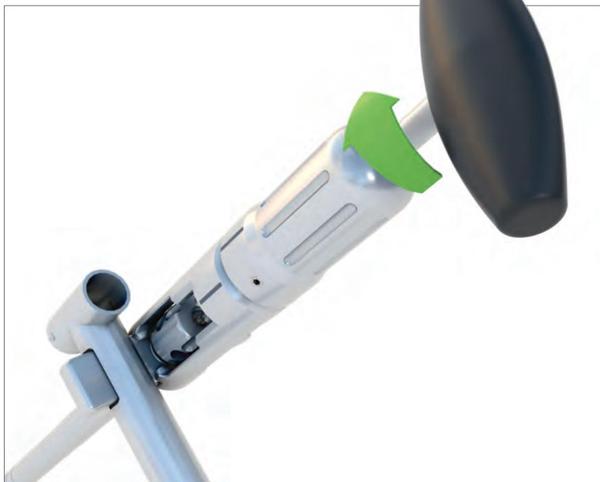
Tourner la poignée du *prétendeur sans torsion (TOV)* dans le sens des aiguilles d'une montre jusqu'à ce que le *goujon* soit coupé en deux. Ainsi, les composants sont verrouillés ensemble et mis en précontrainte.
