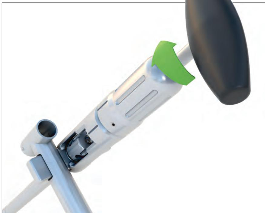
Ruotare in senso orario l'impugnatura dello *strumento di precarico senza torsione (TOV)*, fino a quando il *bullone a strappo* è tagliato da parte. Quindi i componenti vengono bloccati insieme e pretensionati.
