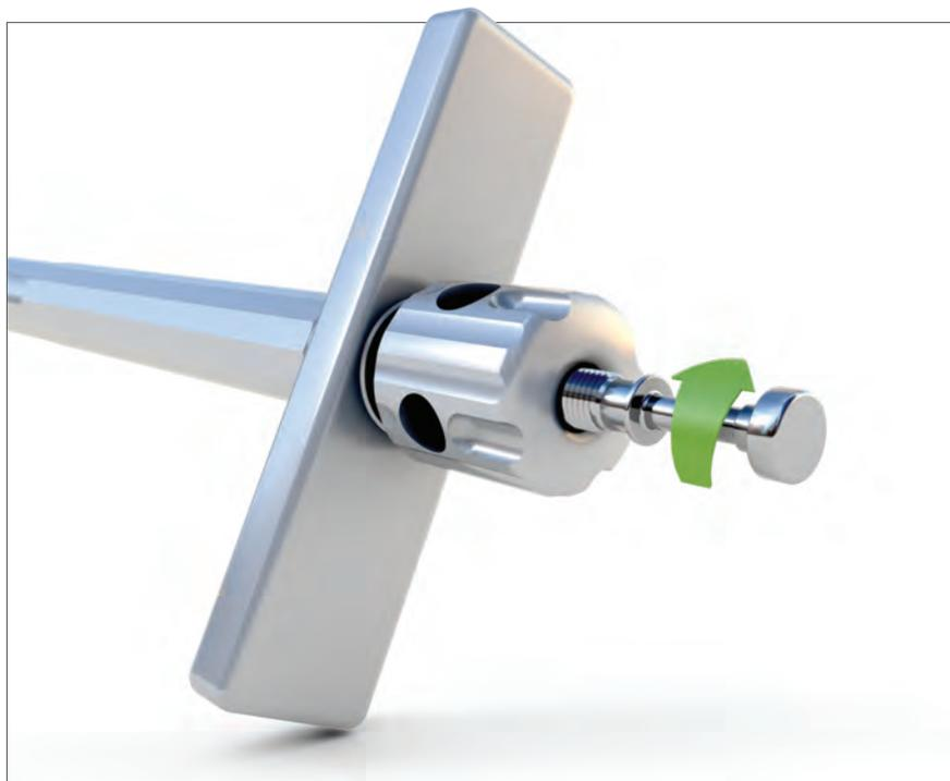
Allineare le marcature sullo *strumento di precarico senza torsione* (TOV). Accertarsi che il ricevitore del bullone sia esteso.
