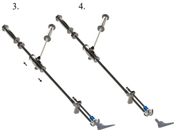
Rimuovere la testa femorale battendola **delicatamente** con l'insieme impattore/peso d'impatto.
