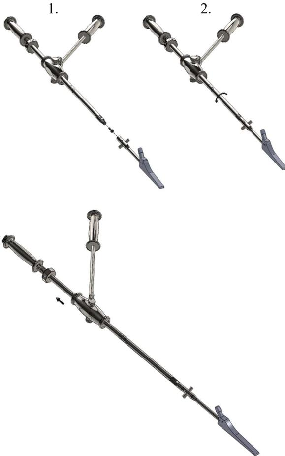
A questo punto, avvitare lo strumento di estrazione all'adattatore speciale. Tenere saldamente l'impattatore e il peso e ruotare lo strumento di estrazione intorno al suo asse, come illustrato (freccia).
