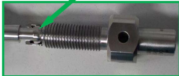
Poi inserire l'unità vite di pressione/mandrino nel tubo guida dell'adattatore (c) e avvitare inizialmente con soli due o tre giri. Osservare la posizione corretta della superficie sul mandrino; le **freccie sull'adattatore e sul mandrino** devono essere rivolte l'una verso l'altra.
