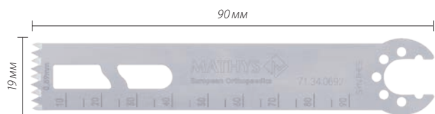
Стерильное полотно для осциллирующей пилы 90x19x0,89
