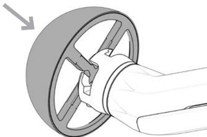
Tournez dans le sens des aiguilles d'une montre pour connecter la fraise.
