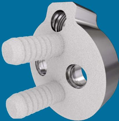
Die Metaglene aus Titan ist nicht nur frei von Nickel, sondern ermöglicht dank ihrer Oberfläche auch eine zementfreie Verankerung des Implantates. Die zweifache Beschichtung aus Titan-Plasmaspray und einer resorbierbaren Calciumphosphat-Verbindung, welche die Osseointegration durch ihre osteokonduktive Wirkung beschleunigt, trägt zu einer guten Primärstabilität und dauerhaften Sekundarstabilität bei.
